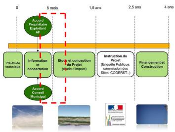
Le développement d'un parc éolien est un processus long dû aux démarches, études et obtentions des autorisations nécessaires à sa construction (voir schéma ci-contre). Parmi les études, l'analyse écologique du site et les mesures de vent doivent être menées sur un cycle annuel complet.
